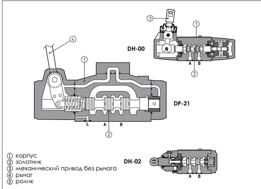
Распределители с ручным и механическим управлением, золотникового типа, трех- или четырехлинейные, двух- или трехпозиционные, предназначены для работы в гидравлических системах.
