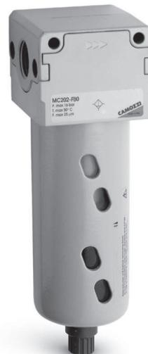
Доступны коалесцентные фильтры Серии MC с присоединением G1/4, G3/8 и G1/2. Стаканы этих фильтров сделаны из металла с окошками из прозрачного пластика и имеют конденсатоотводчик, работающий в ручном/полуавтоматическом режиме. Кроме того, также возможен заказ фильтров с автоматическими конденсатоотводчиками.
