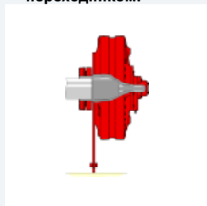
▲ Гидромотор, монтируемый на кронштейн, с фланцевым переходником.
